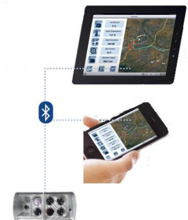
In het voertuig, kan een tablet of smartphone de gemeten data grafisch weergeven en doorsturen naar een centrale database
